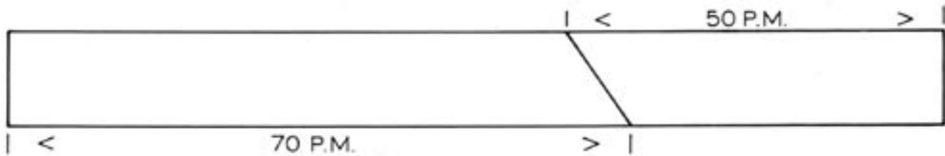
Abb. 12: Prahm 4 aus Zwammerdam. Schema eines Plankengangs, dessen Gesamtlänge kürzer ist als die Summe der beiden Plankenlängen von 70 und 50 römischen Fuß (*pedes monetales*).
